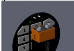
Bild 2. Kontakte zur Notbestromung
